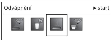
Během jednotlivých odvápněvacích postupů bliká tlačítko **8 start**. Číslice vpravo nahore zobrazují jednotlivé fáze programu.
