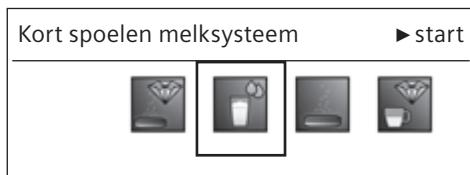
Het melksysteem **10** kan automatisch worden voorgereinigd.
