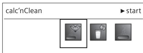
Během jednotlivých postupů calc'nClean bliká tlačítko **8 start**. Číslice vpravo nahore zobrazují jednotlivé fáze programu.
