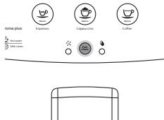
Wanneer de CALC CLEAN-knop onafgebroken brandt, moet u het apparaat ontkalken. Als u het apparaat niet ontkalkt wanneer deze knop dit aangeeft, werkt het apparaat mogelijk niet meer naar behoren. In dat geval vallen reparaties niet onder de garantie.
