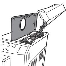
**4** Open het deksel van het bonenreservoir. Vul het bonenreservoir met koffiebonen en sluit het deksel.
