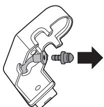
**5** Retirez le tuyau avec la douille.
