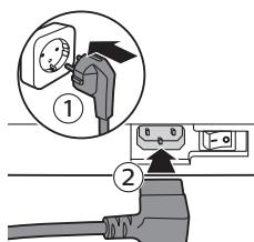
**5** Steek de stekker in een stopcontact (1) en steek de kleine stekker in de aansluiting op de achterkant van de machine (2).
