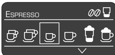
Nella riga di stato **5a** del display **5** viene visualizzato il nome del tipo di bevanda e il valore impostato per l'intensità, ad esempio **00** e per la quantità, ad esempio **■**. La riga di selezione **5b** rappresenta i simboli per la selezione delle bevande.
