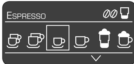
In de regel 'status' **5a** van het display wordt de naam van de drank en de ingestelde sterkte, bijv. **00**, en hoeveelheid, bijv. **□**, vermeld. In de regel 'keuze' **5b** verschijnen symbolen voor de drankkeuze.
